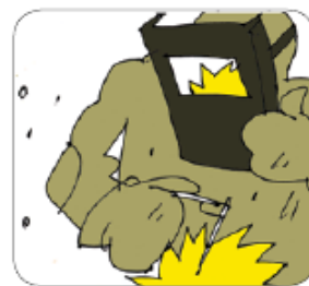
Проведение огневых работ без оформления соответствующего наряда-допуска
